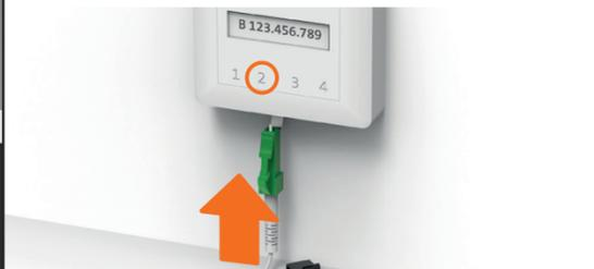
Funziona solo uno slot. Rimuovere il cappuccio di protezione. Aprire lo slot specificato sulla presa in fibra ottica (di solito "2", raramente "1"). Nota: se le connessioni sono montate verso l'alto, lo slot 2 è il secondo da destra. Per rimuovere il cavo, vedere la pagina posteriore.
