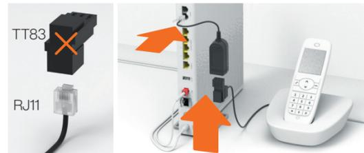
Hai questo tipo di presa (RJ11)? Se non ce l'hai, hai bisogno di un adattatore per telefoni RJ11/TT83.
