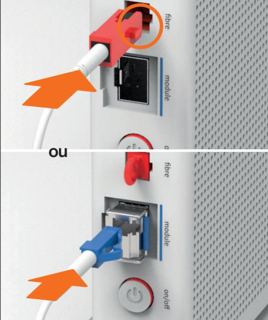
Utilisez le nouveau câble fibre optique. Retirez les embouts de protection et raccordez l'extrémité rouge ou bleue du câble fibre optique à l'Internet-Box. Ne touchez pas les extrémités du câble. Port fibre optique bleu: branchez impérativement la sécurité du module pour que le câble tienne bien.
