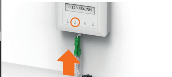
Fonctionne à un seul endroit: retirez l'embout de protection. Sur la prise fibre optique, ouvrez l'emplacement prédéfini (en général le «2», rarement le «1»). **Important:** si les ports sont placés en haut, l'emplacement 2 est le deuxième en partant de la droite. Pour débrancher le câble, voir au verso.
