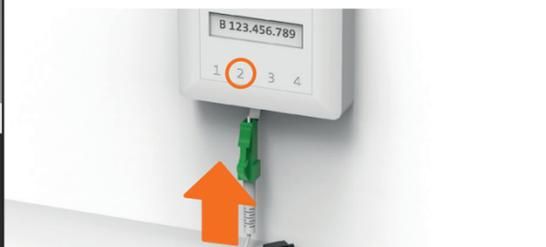
Nur ein Steckplatz funktioniert: Nimm die Schutzkappe ab. Öffne bei der Glasfasersteckdose den vorgegebenen Steckplatz (in der Regel «2», selten «1»). Achtung: Falls deine Anschlüsse gegen oben montiert sind, ist Steckplatz 2 der zweite von rechts. Zum Entfernen des Kabels siehe Rückseite.
