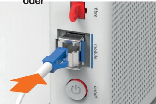
Verwende das neue Glasfaserkabel. Nimm die Schutzkappen ab, und schliesse das rote beziehungsweise blaue Ende des Kabels an der Internet-Box an. Berühre das Kabel nicht an den Enden. Blauer Glasfaseranschluss: schliesse unbedingt die Sicherung des Moduls, damit das Kabel auch richtig hält.
