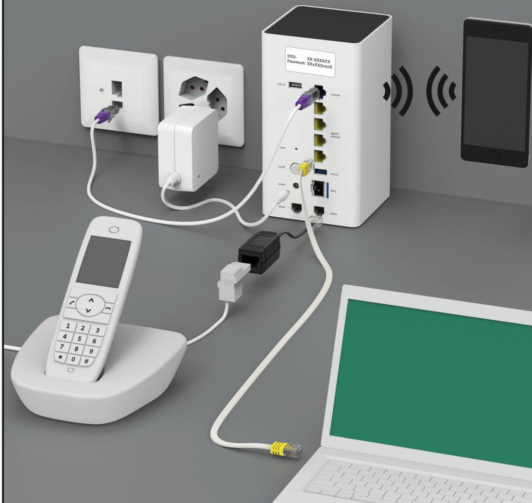
**4** Schliesse das DSL-Kabel an der Internet-Box an.
